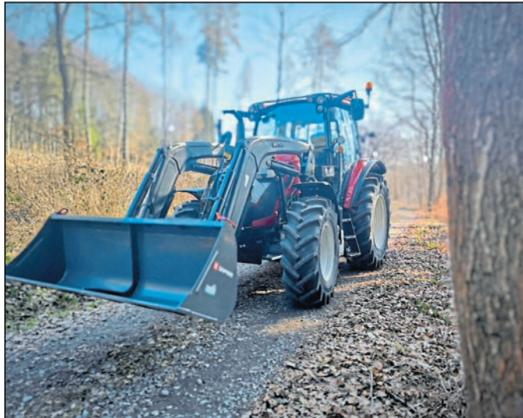
Das Fahrzeug, ausgestattet mit Frontlader, Schaufel und Forstseilwinde, ist flexibel einsetzbar.
