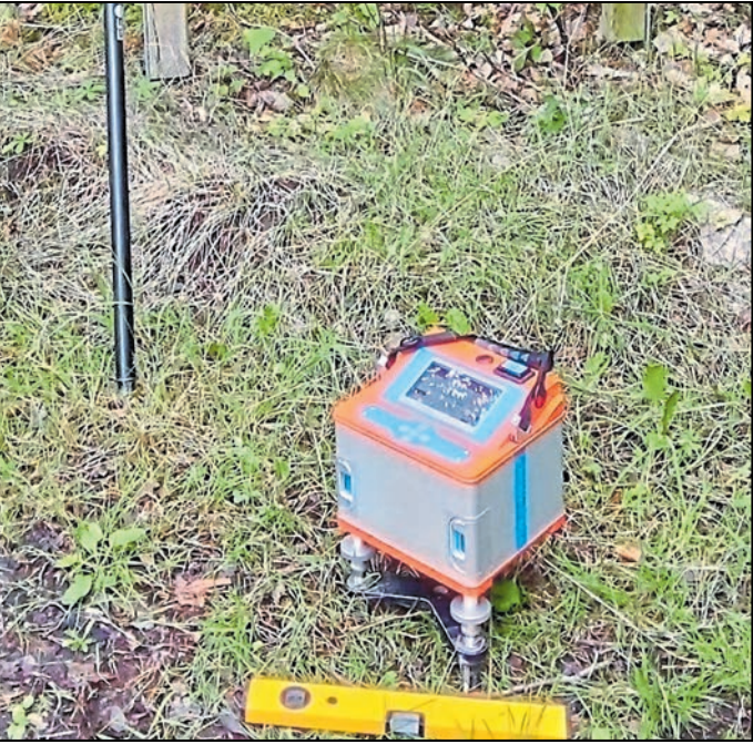
Gravimeter „scannen“ in den kommenden Tagen den Untergrund im Norden des Landkreises Bautzen Fotograf: Geophysik GGD mbH
